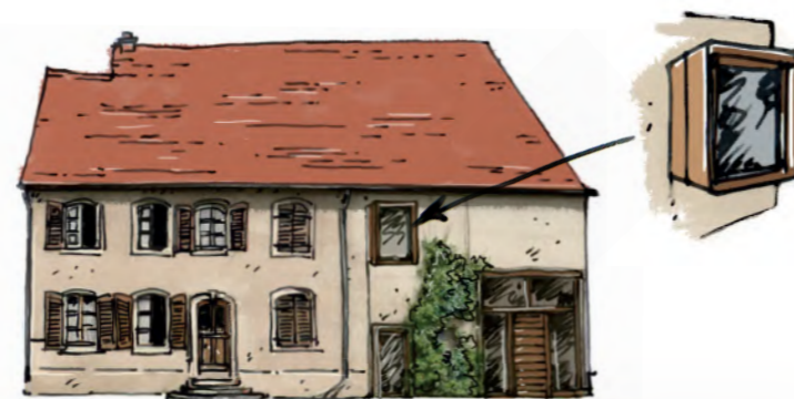
Création d'une nouvelle ouverture en saillie et transformation d'usage de la porte charretière.
