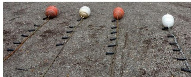
Photo 1 : Installation des chaînes munies de thermomètres enregistreurs.
