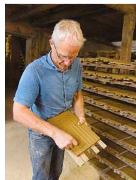
Le modelage de surface des tuiles est renforcé à la main pour mieux canaliser les eaux de pluie.
