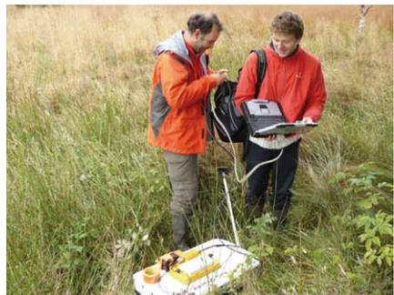
Prise de mesures géophysiques à l'aide d'un géoradar.
