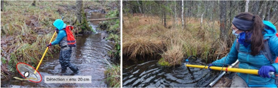
Figure 9 : Prospections mobiles réalisées à pied dans le Rothenbach et en bateau le long de la rive gauche de l'étang, avec illustration de la portée de détection avec les PIT tags de 12 mm
